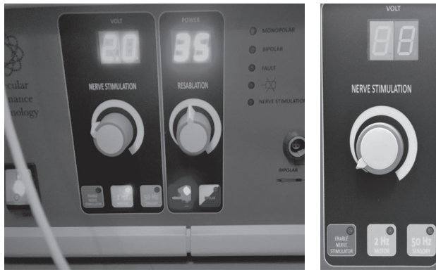
Fig. 1. Nuevo generador de energía que se acoplará al Resaflex®. Nótese las características en el generador que permiten realizar estimulación y radiofrecuencia coablativa. En detalle se aprecia que se permite realizar estimulación motora (2 Hz) y sensorial (50 Hz).
