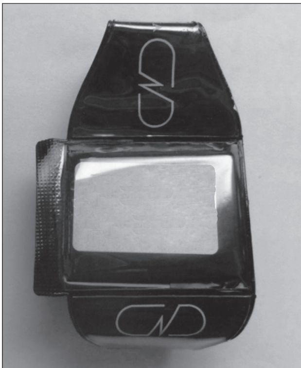
Fig. 4. Dosímetro de película.
